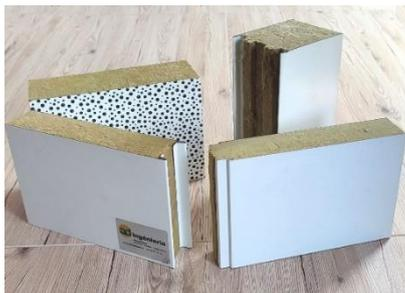
Panneaux constitués de deux parements en tôle et âme en fibre de roche volcanique à haute densité, inorganique, imputrescible, chimiquement neutre et amorphe : aucune action corrosive, non hydrophile : aucune remontée capillaire. Le montage se fait par emboîtement.
